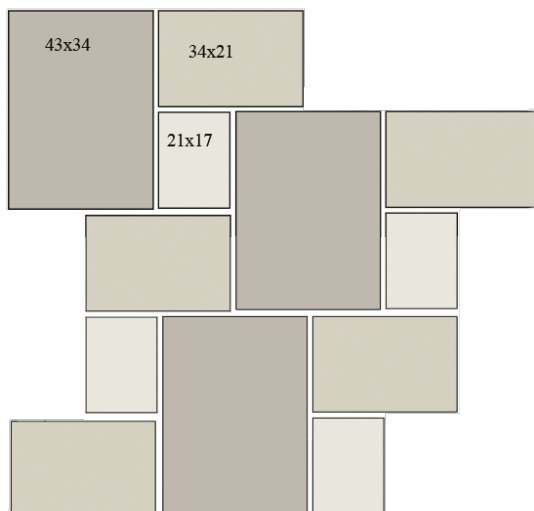
Verlegemuster für die Pflasterplatten der Gallo Serie
