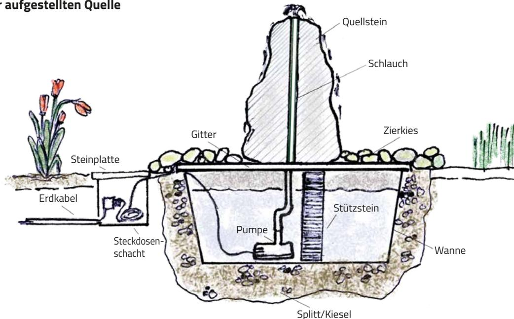
Quellsteine sind besonders schöne Gestaltungsobjekt für den Garten, die zudem einen geringen Pflegebedarf haben. Der Unterbau wird am einfachsten mittels einer im Boden vergrabenen Kunststoffwanne vorbereitet. Diese sollte waagrecht auf ein Splittbett gesetzt und nach dem Befüllen mit Wasser ringsum mit Splitt und Sand eingeschwemmt werden. Die Wanne wird mit dem passenden Metallgitter abgedeckt, welches durch einen Stützstein stabilisiert wird.
